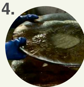
Después de moler el mineral durante horas, los lodos son lavados las veces que sean necesarios para obtener un concentrado de oro y mercurio el cual es la amalgama.
