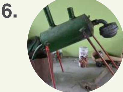
Instrumento utilizado para recuperar el mercurio en la quema de la amalgama.
