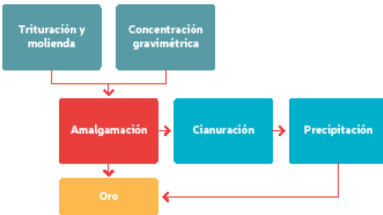
Figura 1. Pasos del proceso de beneficio del oro en la pequeña minería.
